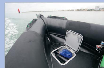
La baïlle est placée sous le plancher du cockpit. La console dispose d'une assise sur sa partie antérieure.
