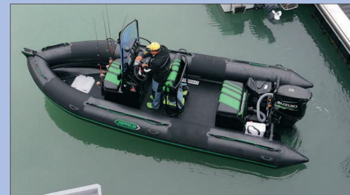
L'aménagement du bateau se fait à la carte. Le modèle de notre essai dispose d'une console décalée sur tribord pour faciliter la circulation à bord.
